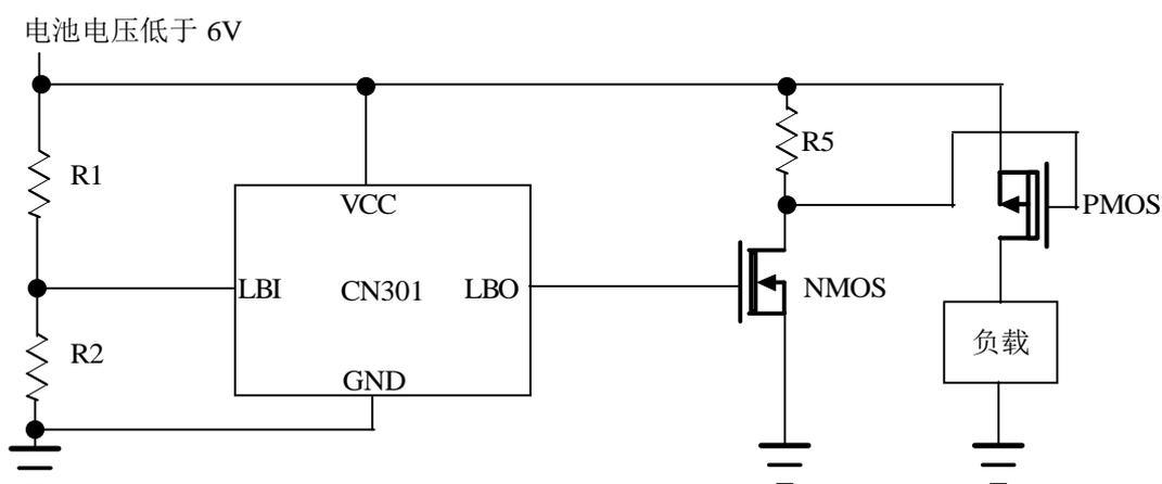
图7 电池最高电压低于6V，CN301控制PMOS晶体管
