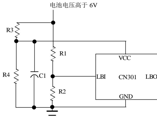
图9 利用两个电阻分压为CN301供电
