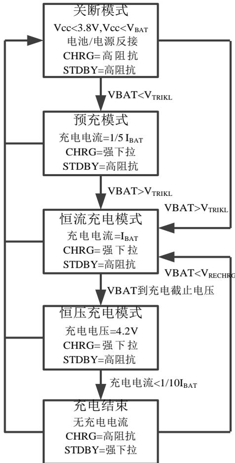
图4 一个典型充电循环的状态图
